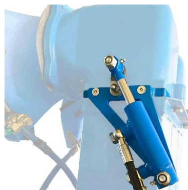
Coupure d'air hydr. sur la moitié de la longueur
